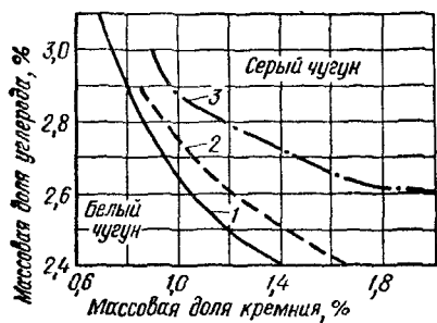
Рис. 7.4. Влияние добавок висмута и теллура на отбел чугуна:
